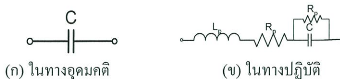
รูปที่ 2.11 องค์ประกอบแฝงของตัวเก็บประจุไฟฟ้า
