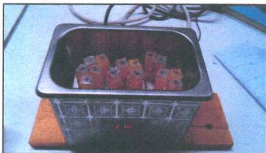
รูปที่ 3.11 การสั่นตัวอย่างด้วยเครื่อง Ultrasonic
