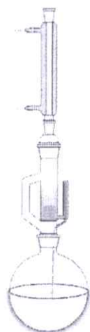
รูปที่ 2.15 เครื่องสกัดซอกซ์เล็ต[4]
