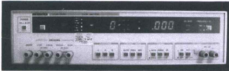
รูปที่ 3.8 LCR meter ยี่ห้อ LEADER รุ่น LCR-746
