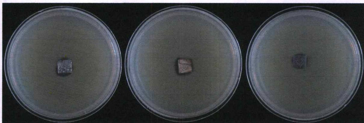
รูปที่ ๓ ภาพแสดงการต้านทานเชื้อ E. Coli ของฟิล์มสูตร HC25SA75Ca0.5Ag5
