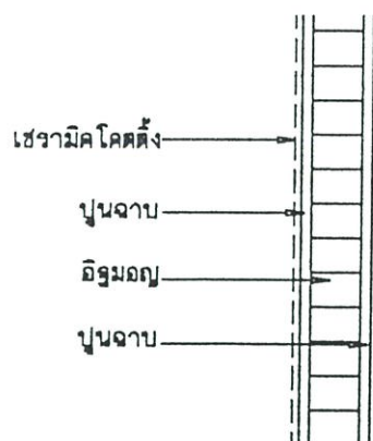
ภาพที่ 5.4 แสดงลักษณะการปรับปรุงผนังภายนอกด้วยการติดตั้งฉนวนเซรามิคโคตติง
