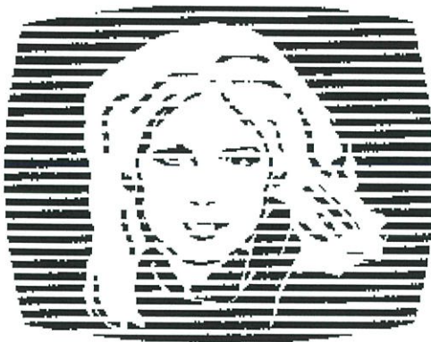
รูปที่ 3.10 ลักษณะภาพที่เกิดจากการรบกวนจากการรบกวนจากวิทยุสมัครเล่น
