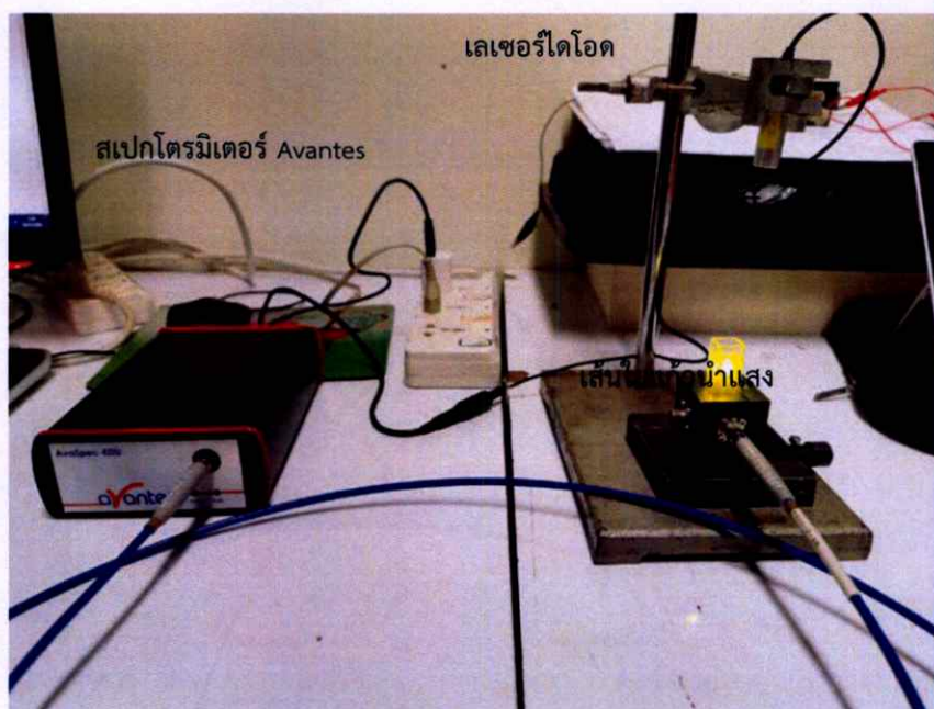
รูปที่ 3.5 ระบบการวัดการเปล่งแสงลูมิเนสเซนซ์
