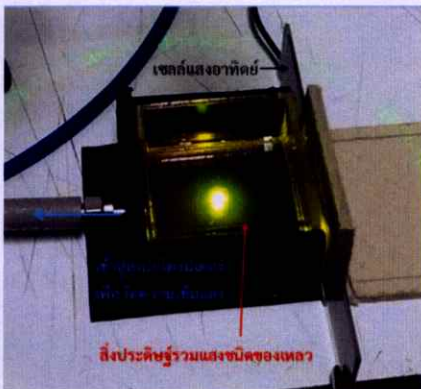
รูปที่ 4 โครงสร้างของสิ่งประดิษฐ์รวมแสงอาทิตย์ชนิดของเหลวที่จัดเตรียมในงานวิจัย
