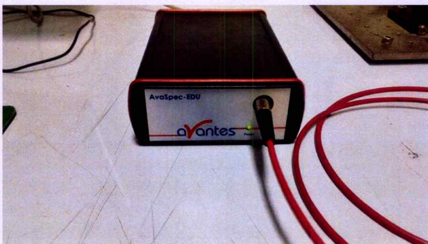
รูปที่ ข.14 ต่อสายไฟเบอร์เข้ากับรูรับแสงของเครื่องสเปกโตรมิเตอร์
