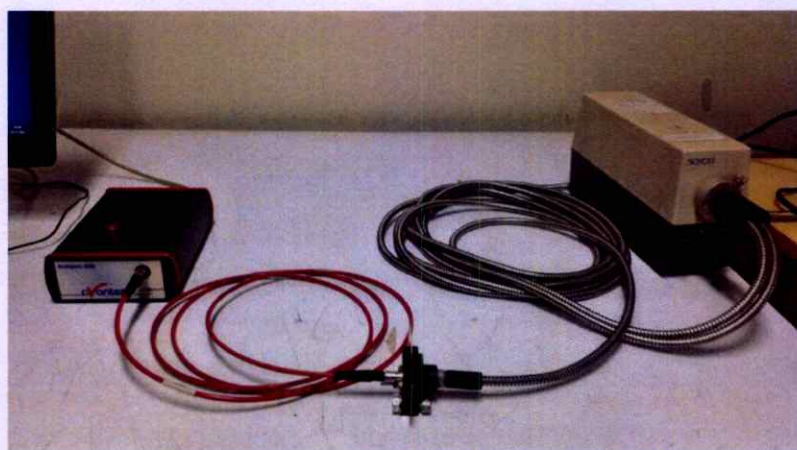
รูปที่ ข.33 การจัดอุปกรณ์เพื่อทำการวัด blank สำหรับการวัดการดูดกลืนแสงของตัวอย่างต่างๆ (ก) วัดการดูดกลืนแสงของสารละลายในคิวเวท, (ข) วัดการดูดกลืนแสงของฟิล์มบางรูปแบบที่ 1 และ (ค) วัดการดูดกลืนแสงของฟิล์มบางรูปแบบที่ 2
