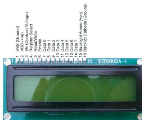
รูปที่ 2.21 ขาเชื่อมต่อ 16 ขาของจอ Liquid Crystal Display (LCD)
