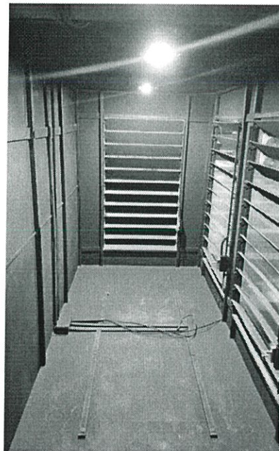
(ก) การจัดวางหลอดไฟภายในชุดทดลอง (ข) ภายในชุดทดลองที่ใช้ศึกษาค่าความเข้มแสง รูปที่ 4.18 ภายในชุดทดลองที่ใช้ศึกษาค่าความเข้มแสงภายในบ้าน
