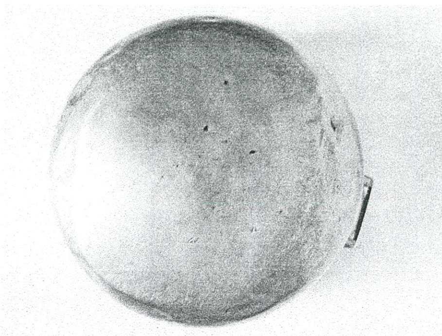
รูปที่ 5.52 แสดงก้นภาชนะที่ภาชนะห่างเตา 4cm
