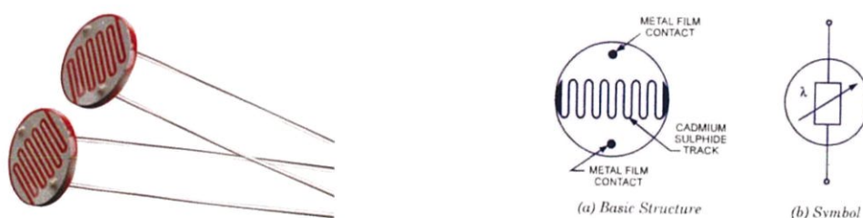
รูปที่ 2.7 LDR และโครงสร้างของ LDR
