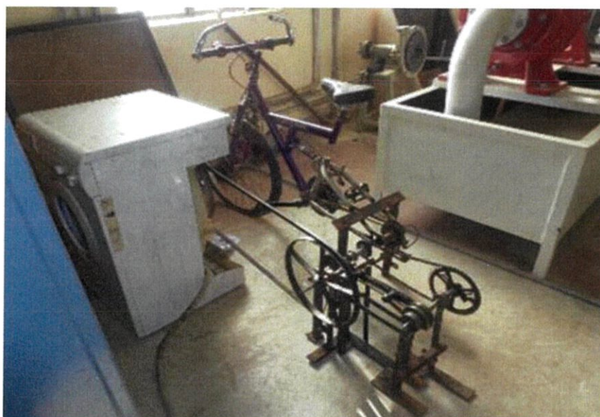
รูปที่ 2.2 เครื่องซักผ้าที่ขับเคลื่อนโดยการปั่น (Ranjan, Sharan and Mazumdar)
