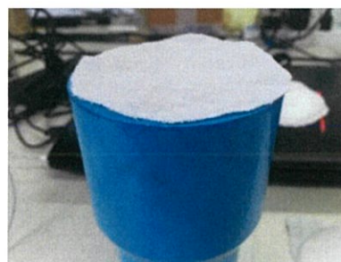
รูปที่ 4.5 ตัดผ้าดิบให้เท่าขนาดท่อPVC
