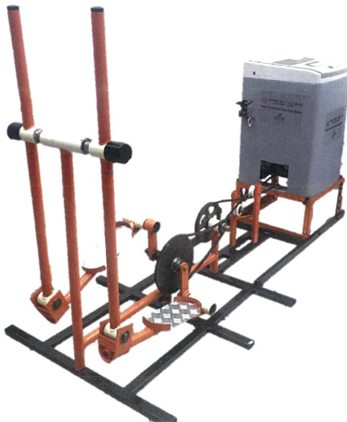
รูปที่ 3.17 แสดงเครื่องต้นแบบของเครื่องจักรยานออกกำลังกายเพื่อเป็นต้นกำลังเครื่องชักผ้า
