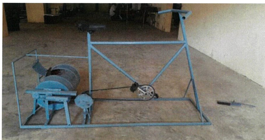
รูปที่ 2.4 pedal operated washing machine (Krishnamurthy, Rakshith, Harshaa and Rakesh)
