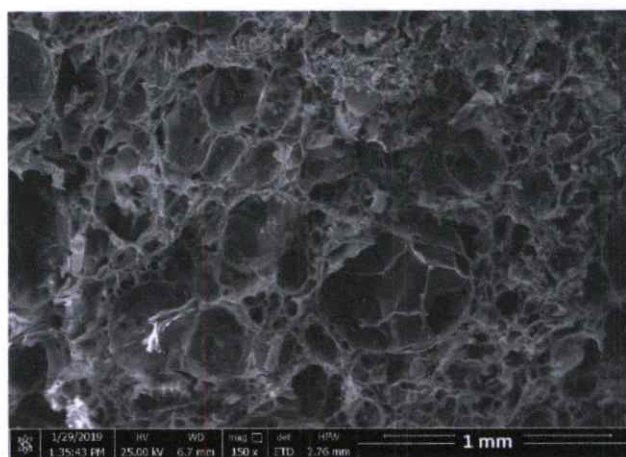
รูปที่ ข-3 ภาพตัดขวางของโครงเลี้ยงเซลล์สูตร SC-0.5-120 ที่กำลังขยาย 150X
