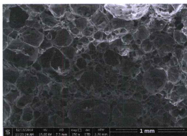
รูปที่ ข-4 ภาพตัดขวางของโครงเลี้ยงเซลล์สูตร SC-1.0-30 ที่กำลังขยาย 150X
