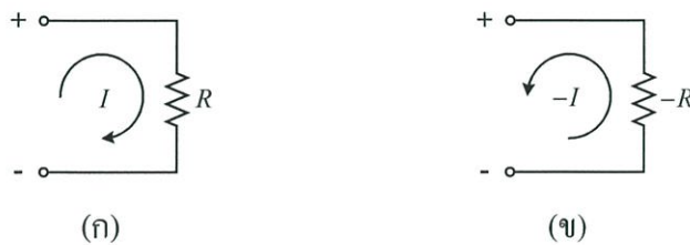
รูปที่ 3.3 ค่าความต้านทานที่เกิดขึ้นในวงจรไฟฟ้า
