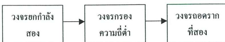
รูปที่ 1.1 บล็อกแสดงการทำงานของวงจรถ่ายค่าราคาที่สองของกำลังสองเฉลี่ย
