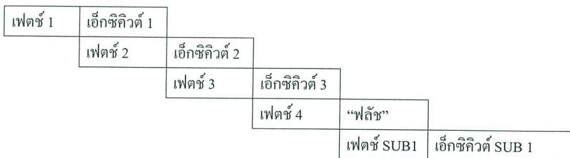
รูปที่ 2.4 การทำงานแบบไปป์ไลน์ที่ใช้ใน PIC16F876
