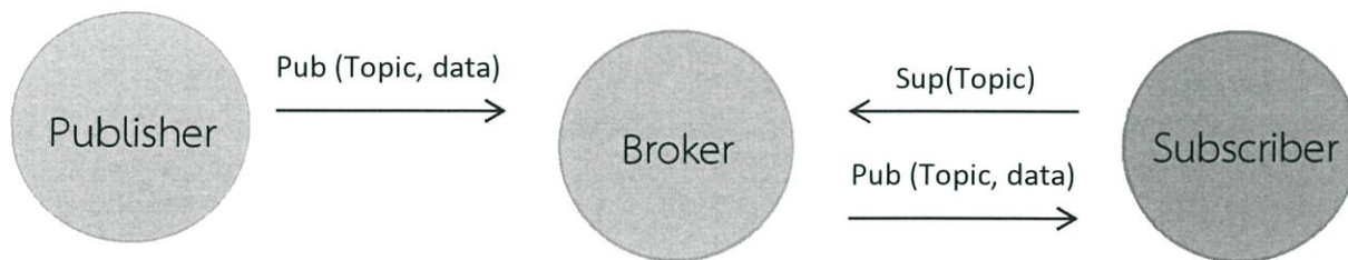
รูปที่ 2.7 รูปแบบการทำงานของ MQTT
