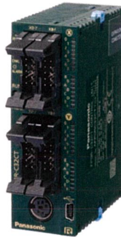
รูปที่ 3.13 Programmable Logic Controller (PLC) Panasonic รุ่น FP0r-C32T
