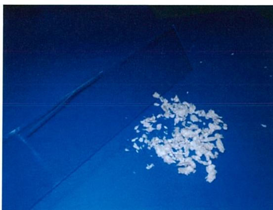
รูปที่ 4.5 ชิ้นงานที่ใช้ในการทดสอบและเม็ดโพลีเมอร์แทนอนุภาคของฝุ่น
