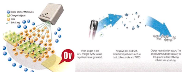
รูปที่ 2.3 การทำงานของเครื่อง Ionizer
