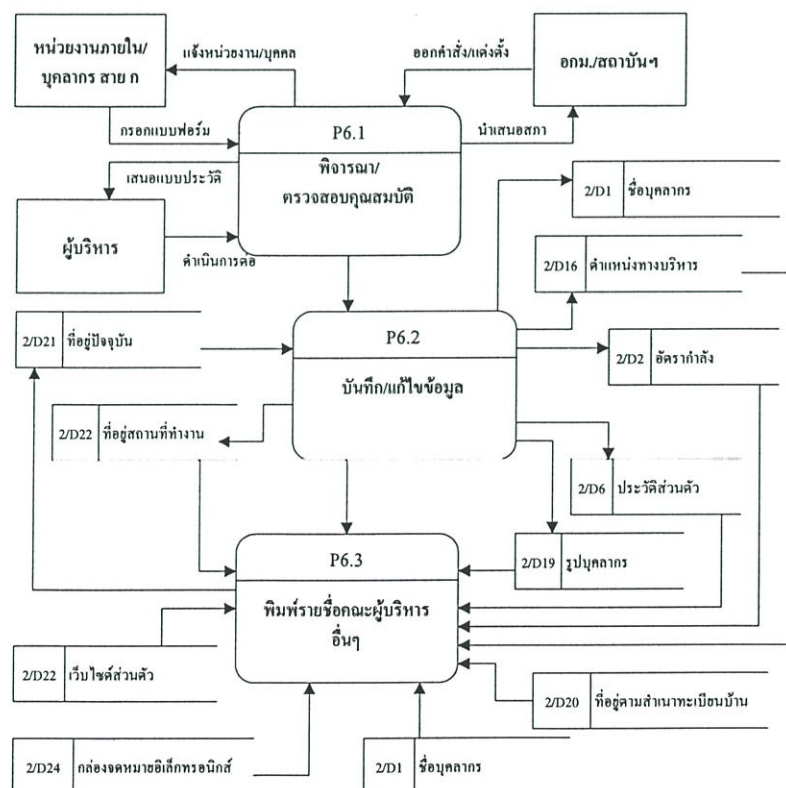
รูปที่ 3.17 Data Flow Diagram Level-2 งานจัดตั้งตำแหน่งผู้บริหาร ของโปรเซสที่ 6
