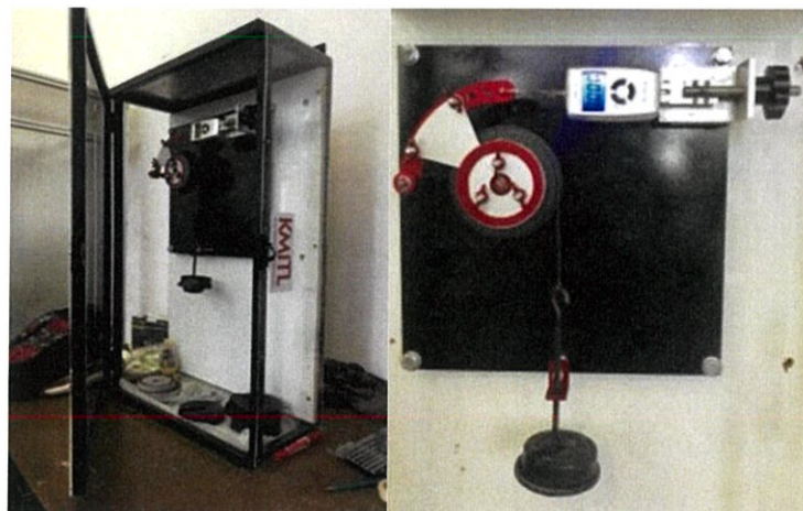
รูปที่ 4.1 แสดงชุดทดลองดรัมเบรกชนิดแผ่นรับแรงเสียดทานจับจากด้านนอก
