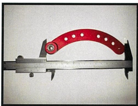
รูปที่ 3.5 ก้านเบรกสามารถปรับองศาของผ้าเบรกได้ 3 ค่า คือ 20^{\circ} - 60^{\circ} , 30^{\circ} - 70^{\circ} และ 40^{\circ} - 80^{\circ}
