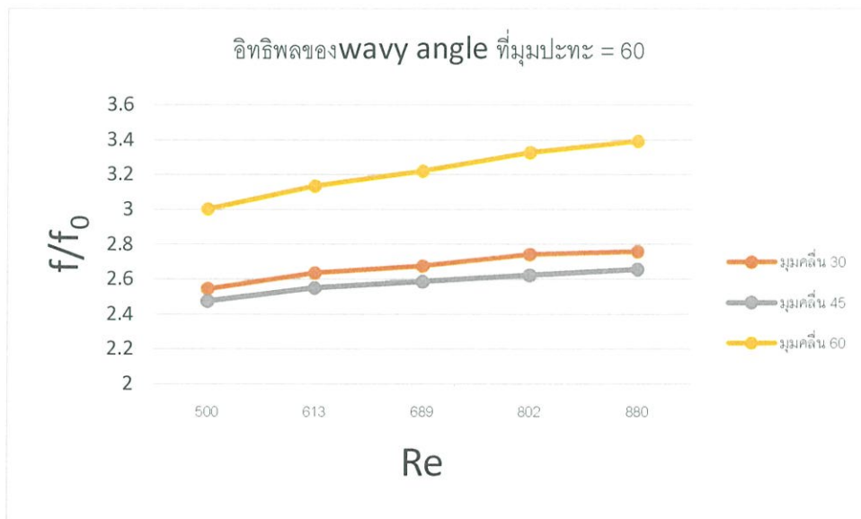
รูปที่ 5.23 อิทธิพลของมุมคลื่นต่อค่าตัวประกอบความเสียดทาน กรณีที่cribหัยก็เป็นแบบเอียงโดยมีมุมปะทะการไหล 60 องศา
