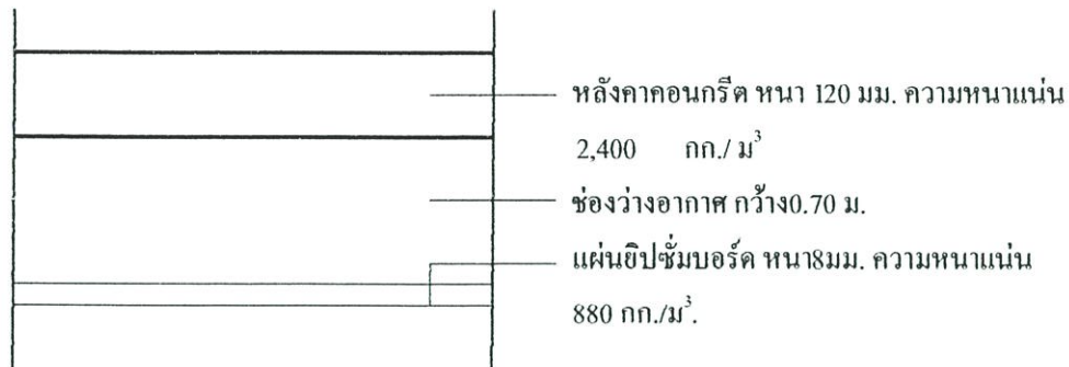
รูปที่ 4.5 แสดงลักษณะ โครงสร้างของหลังคาคอนกรีต
