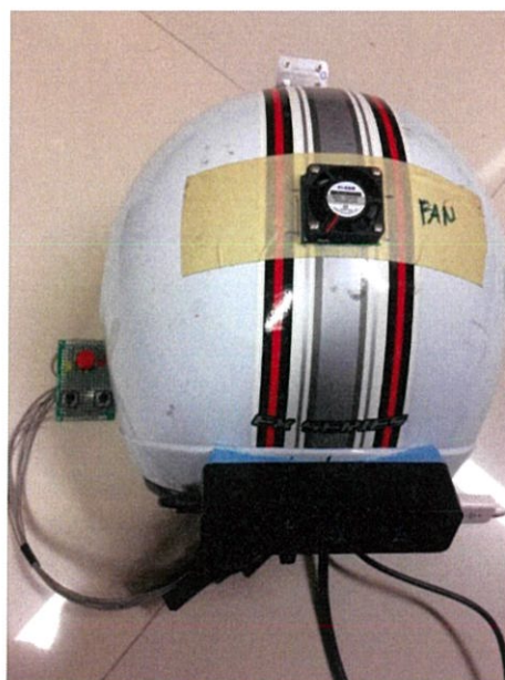
รูปที่ 3.30 พัดลมระบายความร้อนด้านหลังหมวก
