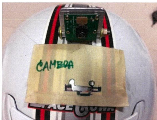
รูปที่ 3.29 กล้องและอุปกรณ์ติดตั้งบนหมวก
