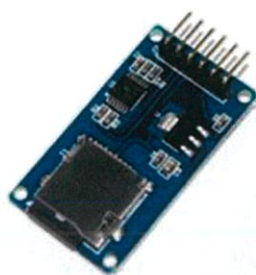
รูปที่ 3.3 โมดูลบันทึกข้อมูล Micro SD Card Module
