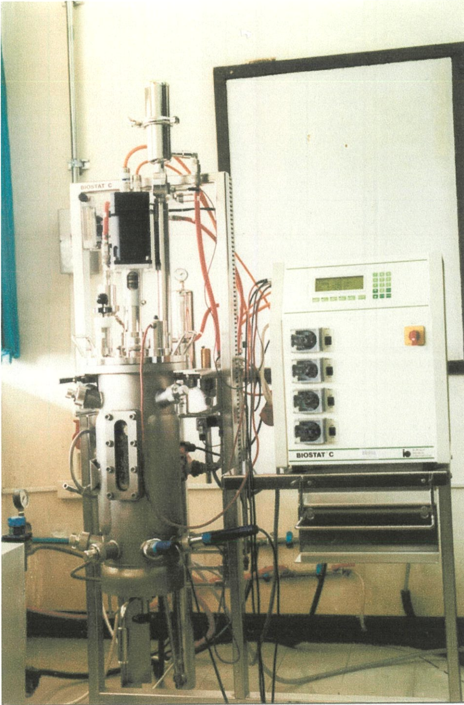
รูปที่ ก.1 แสดงการผลิตกรดโคจิกในถังหมักแบบไบโพัดกวนขนาด 10 ลิตรแบบเบตซ์
