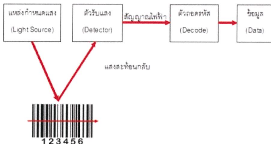
รูป 2.7 สรุปหลักการทำงานของเครื่องอ่านบาร์โค้ด
