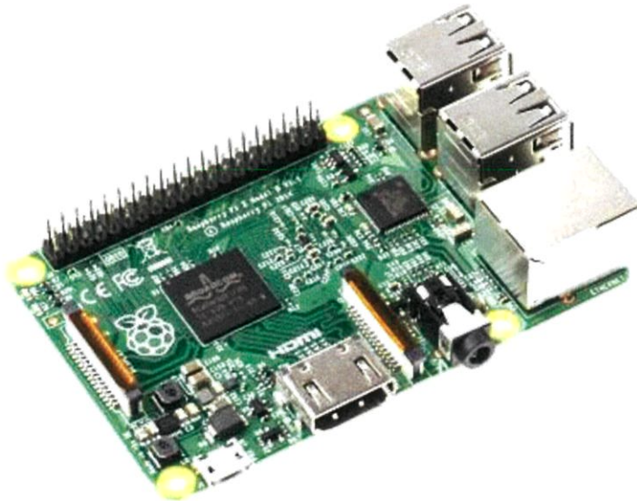
รูปที่ 2.1 ไมโครคอมพิวเตอร์ Raspberry Pi 3 โมเดล B
