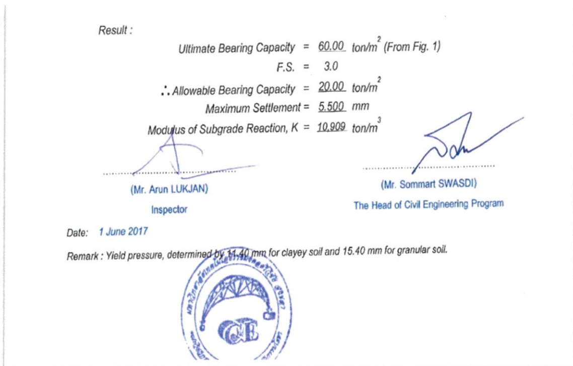
ภาพที่ 3.1 ผลการทดสอบ Plate bearing test โครงการ Mercator Medical Thailand Co. , Ltd.
