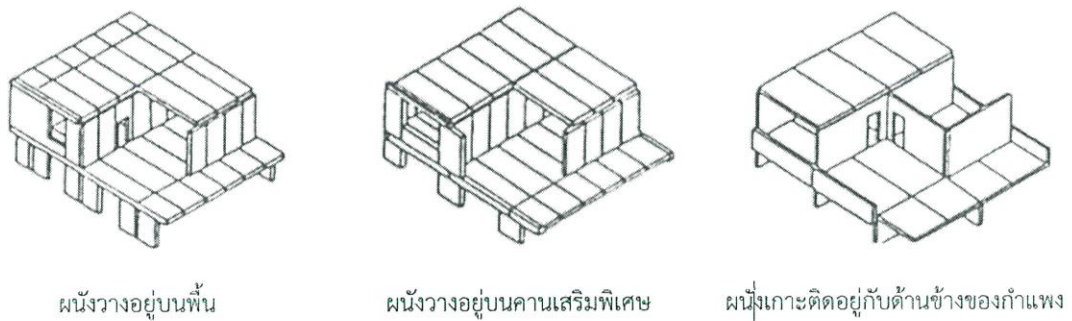
ภาพที่ 2.31 การวางชิ้นส่วนผนังด้านหน้าวิธีต่างๆ ในระบบ cross-wall
