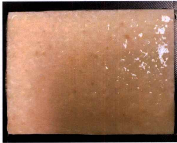
ภาพภาคผนวกที่ ก. 7 เทของผสมลงบนแผ่นอะคริลิกขนาด 20×24 ซม.
