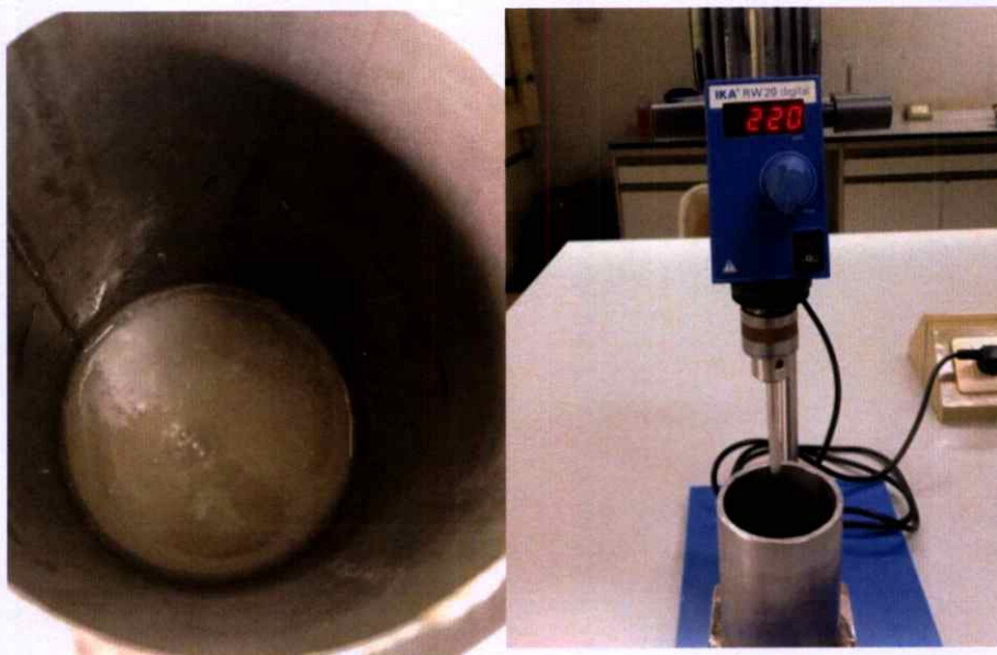
ภาพภาคผนวกที่ ก. 5 ผสมละลายไซโลกลูแคนและโคโตซานเข้าด้วยกันส่วน แล้วกวนผสมต่อด้วย เครื่อง Digital Dual-Range Mixer ความเร็วรอบ 220 รอบต่อนาที เป็นเวลา 2 นาที
