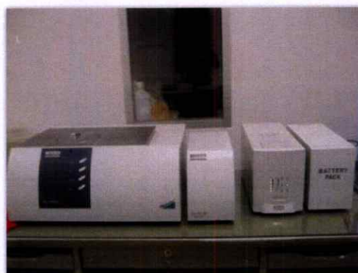
ภาพภาคผนวกที่ ข.2 เครื่อง Differential scanning calorimeter (DSC) ยี่ห้อ Netzsch รุ่น DSC 204 F1 ประเทศเยอรมัน
