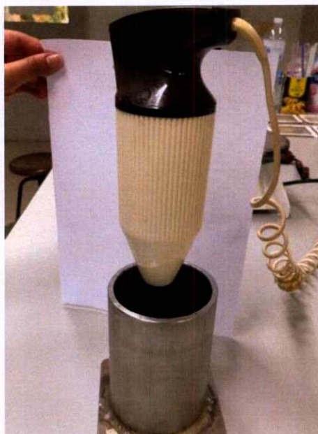
ภาพภาคผนวกที่ ก. 3 ละลายไคโตซานด้วยกรดอะซิติก 4% (ปริมาตร/ปริมาตร) 25 มล. แล้วนำไปกวนผสมโดยใช้เครื่อง Bamix Hand Blender ที่ระดับความเร็วสูงสุด ณ อุณหภูมิห้อง เป็นเวลา 2 นาที
