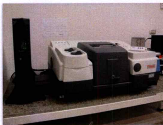
ภาพภาคผนวกที่ ข.1 เครื่อง Fourier Transform Infrared Spectroscopy (FTIR)
