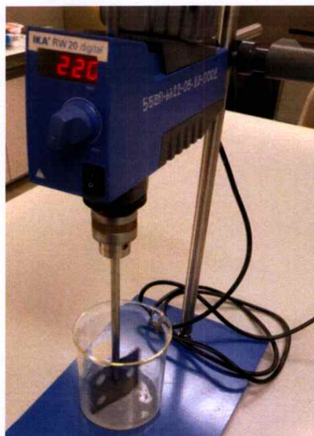
ภาพภาคผนวกที่ ก. 2 ใส่กรดอะซิติก 4% (ปริมาตร/ปริมาตร) 25 มล. แล้วนำไปกวนผสมโดยใช้เครื่อง Digital Dual-Range Mixer ที่อุณหภูมิห้อง เป็นเวลา 30 นาที
