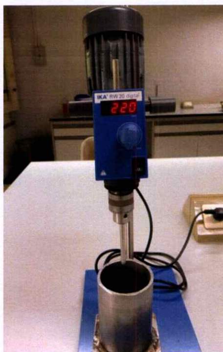
ภาพภาคผนวกที่ ก. 4 กวนสารละลายไคโตซานด้วยเครื่อง Digital Dual-Range Mixer ความเร็วรอบ 220 รอบต่อนาที ที่อุณหภูมิห้อง เป็นเวลา 10 นาที
