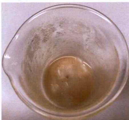
ภาพภาคผนวกที่ ก. 1 ละลายไซโลกลูแคนกับน้ำกลั่นที่มีอุณหภูมิประมาณ 85 °C ปริมาตร 10 มล.
