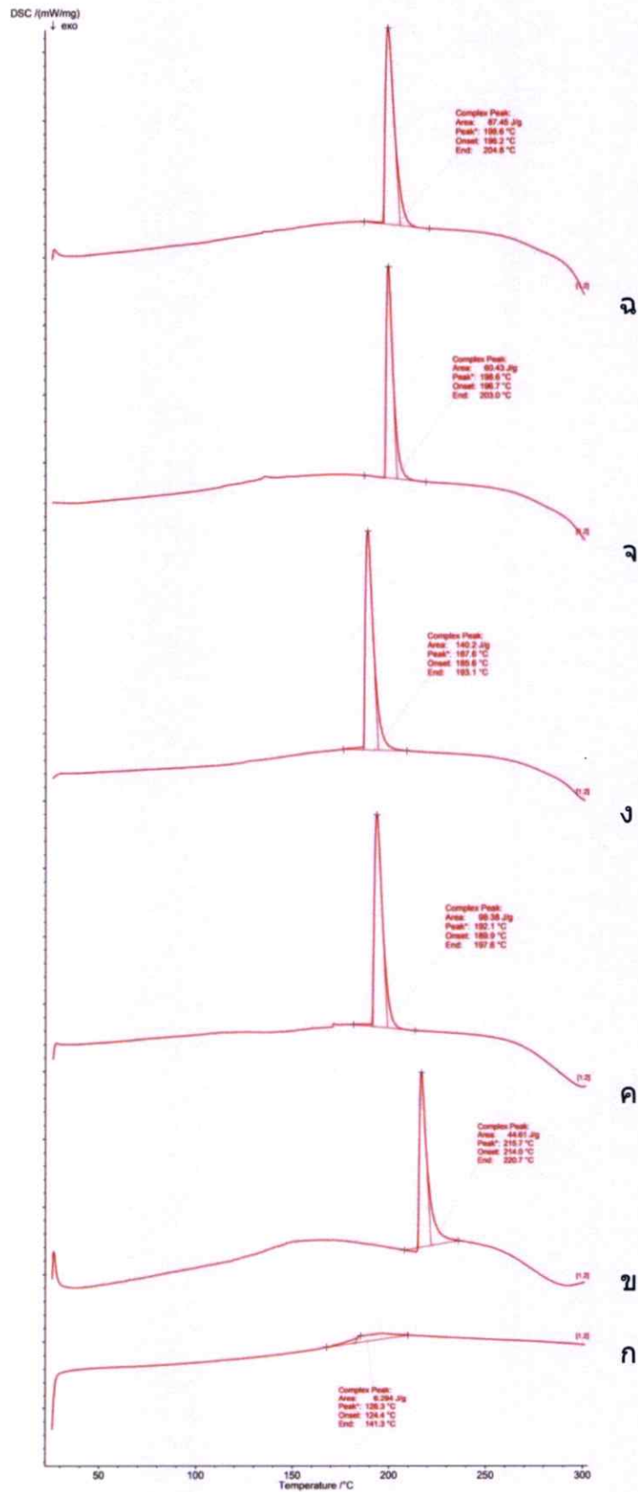
ภาพที่ 4.8 ทอร์โมแกรมแสดงพีคการหลอมตัวของผลึกของ ก) ไซลากลูแคน ข) โคโตซาน ค) อัตราส่วนของไซลากลูแคนต่อโคโตซานที่ 1:1, ง) 2:1, จ) 3:1 และ ฉ) 4:1 ตามลำดับ โดยเติมกลีเซอรอล 35 % (น้ำหนัก/น้ำหนักของของแข็งทั้งหมด)
