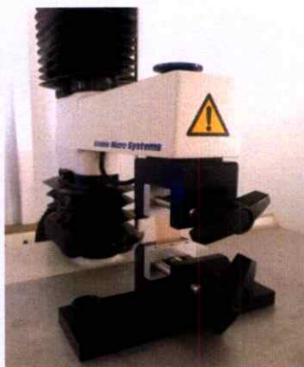
ภาพภาคผนวกที่ ข. 8 ก่อนดิ่งแผ่นฟิล์มคิแตม
