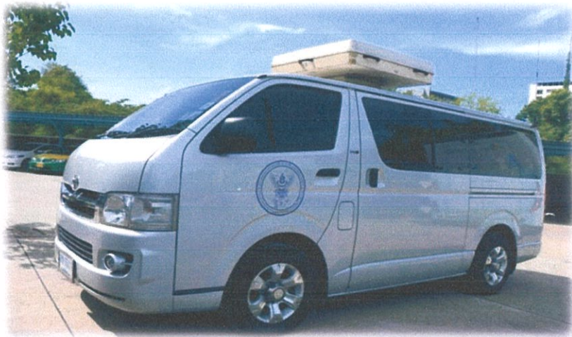
รูปที่ 3.18 รถตรวจสอบ (Mobile Direction Finder : 20 MHz – 1 GHz)
