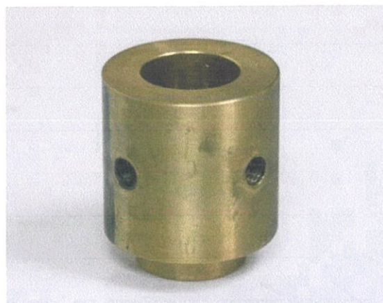
รูปที่ 4.9 ภาพช่วยการกลึงตัวยึดท่อเพื่อให้ได้ขนาดที่ต้องการ และภาพขวาหลังจากเสร็จเรียบร้อยแล้ว
