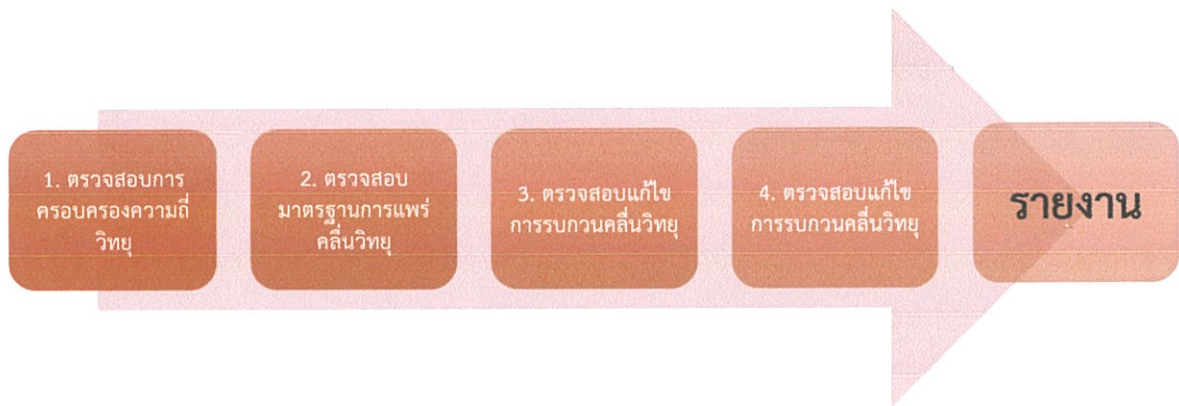
รูปที่ 3.11 บล็อกไดอะแกรมขั้นตอนการตรวจสอบการใช้ความถี่วิทยุ
