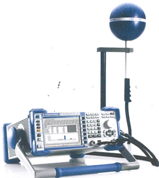
รูปที่ 3.4 Isotropic antennas ต่อกับเครื่อง Spectrum Analyzer ที่ใช้ในการวัด
