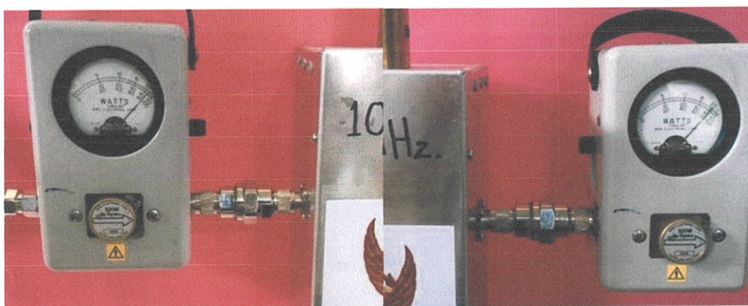
รูปที่ 4.17 การวัดกำลัง (ซ้าย) ก่อนเข้าวงจรกรองวัดได้ 440 วัตต์ (ขวา) หลังผ่านวงจรกรองวัดได้ 410 วัตต์
