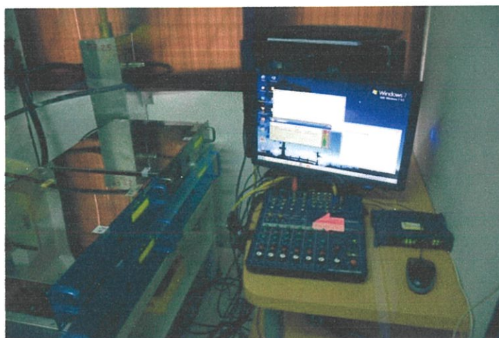
รูปที่ 4.18 การต่อวงจรกรองผ่านแถบกับเครื่องส่ง
