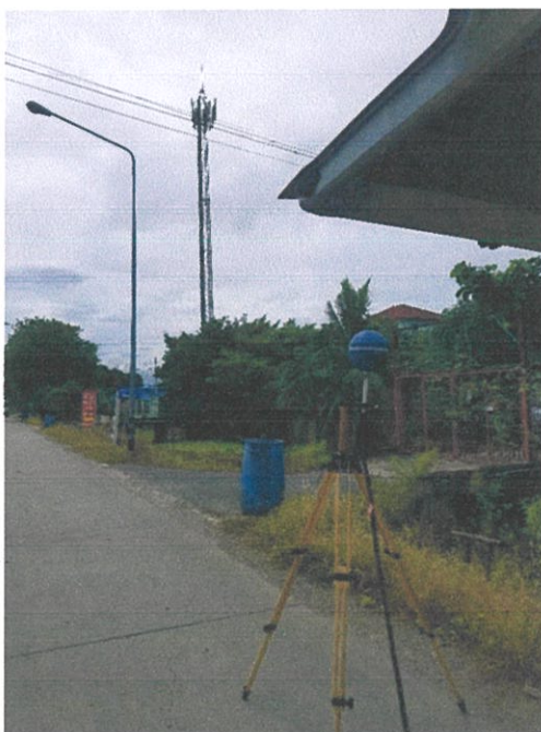
รูปที่ 3.5 ตัวอย่างตำแหน่งที่ทำการวัดสัญญาณในระยะ 5-50 เมตรจากสถานีฐานและต้องทำการวัดสัญญาณซ้ำในลักษณะที่ทุก 101-200, 201-300, 301-400, 401-500 เมตร ถัดไปตามลำดับ
