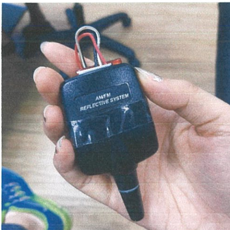
รูปที่ 2.14 เครื่องตัดสัญญาณวิทยุชนิดพกพา (Jammer)
