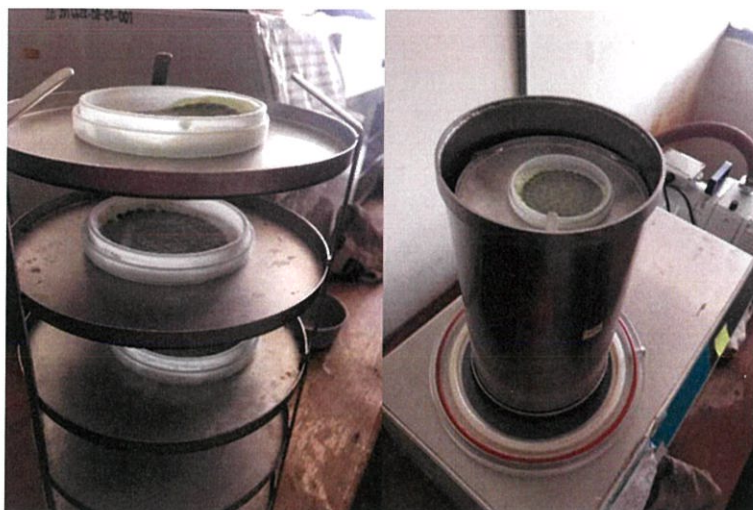
รูปที่ ๔ การนำเซลล์สาหร่ายนำเข้าเครื่องทำแห้งภายใต้ความเย็นและสุญญากาศ
