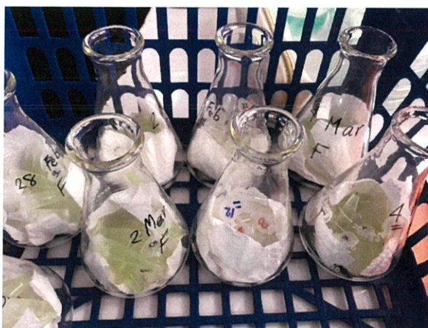
รูปที่ จ1 สารผสมระหว่างเซลล์สาหร่ายกับสารละลายเอทานอลความเข้มข้นร้อยละ 95
