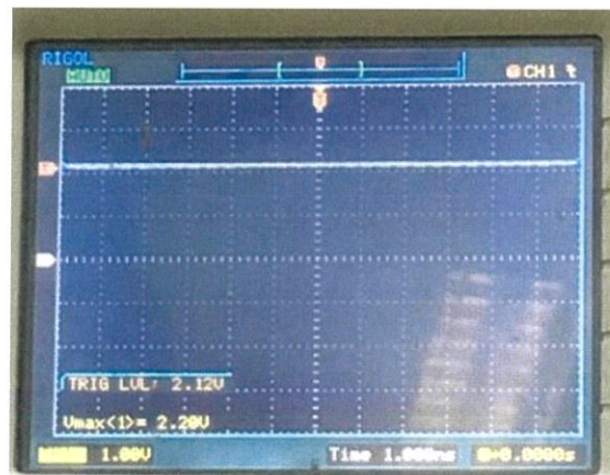
ภาพที่ 4.17 สัญญาณที่ขา Tx หลังส่งข้อมูล
