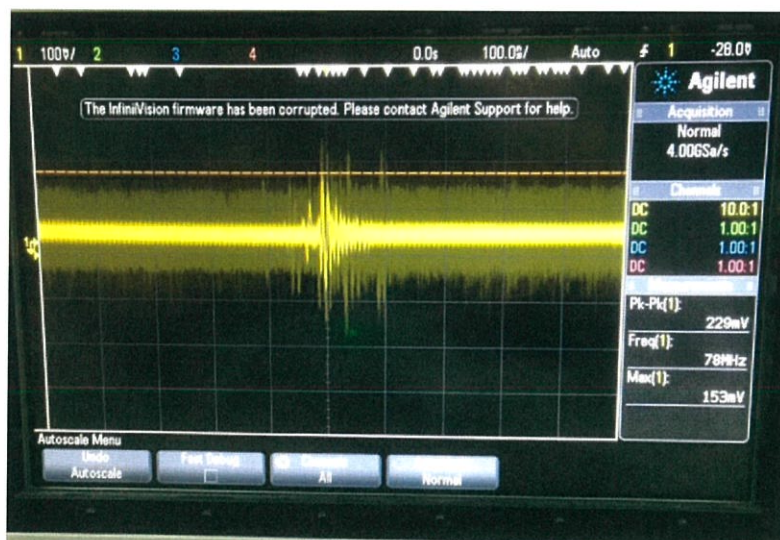
ภาพที่ 4.5 สัญญาณที่ขา Tx1 หลังส่งข้อมูล
