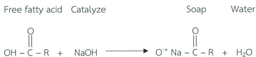
รูปที่ 2.4 ปฏิกิริยาสะพอนิฟิเคชัน (Saponification)
