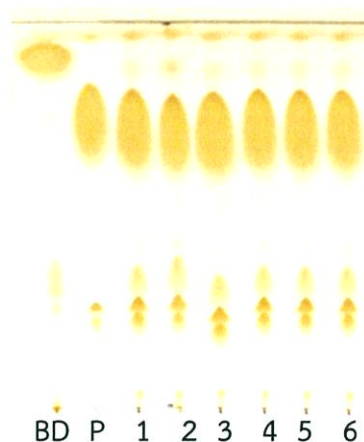
รูปที่ 4.6 ผลการตรวจสอบองค์ประกอบทางเคมีด้วยเทคนิค Thin Layer Chromatography ของ (BD) ไบโอดีเซลมาตรฐานสวนจิตรลดา (P) น้ำมันปาล์ม และผลผลิตไบโอดีเซลที่สภาวะ อุณหภูมิ 61.82 องศาเซลเซียส ปริมาณเอนไซม์ร้อยละ 35 และอัตราส่วนระหว่าง เมทานอลต่อน้ำมัน 3:1 ของแบคทีเรีย Burkholderia sp. รหัส (1) BG2015 (2) BG2018 และ Pseudomonas sp. รหัส (3) KS2002 (4) KS3005 (5) SN2006 (6) SS1003
