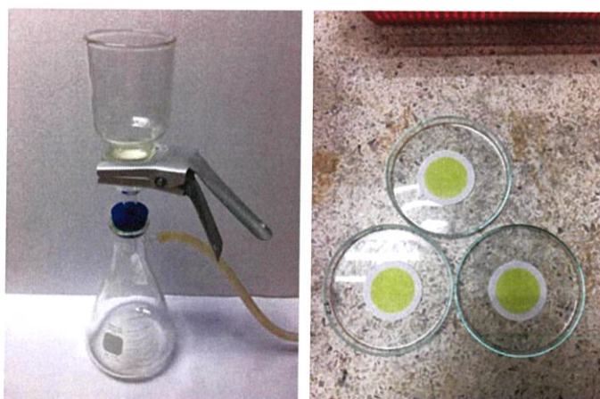
รูปที่ 3.5 แสดงภาพเครื่องกรองสุญญากาศ (ซ้าย) และกระดาษกรองที่มีเซลล์สาหร่าย (ขวา)
