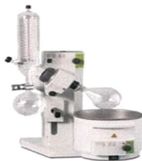
รูปที่ 2.3 เครื่องกลั่นระเหยแบบหมุนภายใต้สุญญากาศ ที่มา : stdb.most.go.th/equipment_detail.aspx?Id=886
