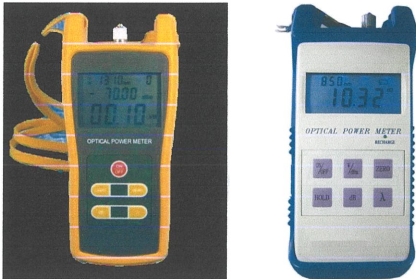
รูปที่ 2.26 แสดงลักษณะภายนอกของเครื่องวัดกำลังแสง
