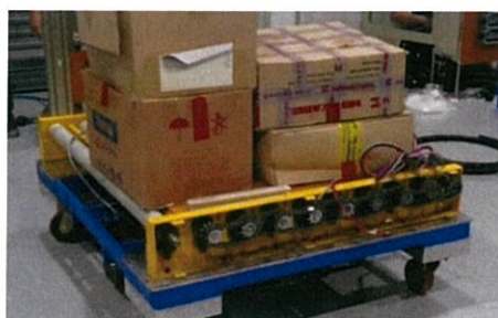
รูปที่ 4.10 การทดสอบโครงสร้างกลไกการทำงานของรถขนส่งอัตโนมัติ
