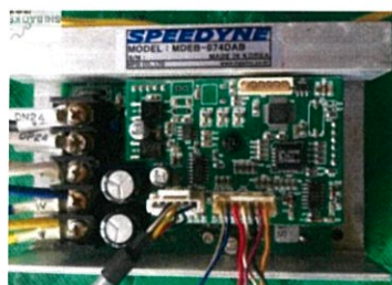
รูปที่ 3.7 วงจรควบคุมมอเตอร์กระแสตรง 3 สาย
