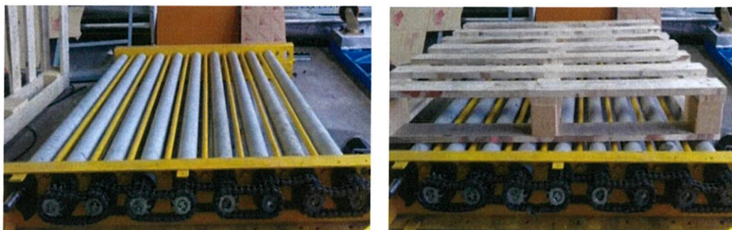
รูปที่ 4.9 การทดสอบกลไกขนส่งเครื่องอัดน้ำยาประเภทโรลเลอร์คอนเวเยอร์
