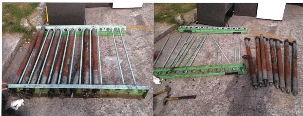
รูปที่ 4.3 โครงสร้างกลไกการขนส่งประเภทโรลเลอร์คอนเวเยอร์เก่า
