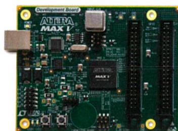
รูปที่ 3.9 อุปกรณ์ลอจิกซับซ้อนแบบโปรแกรมได้ รุ่น ซีพีแอลดี แมกซ์ ไฟว์ เดเวลอปเมนต์ คิท
