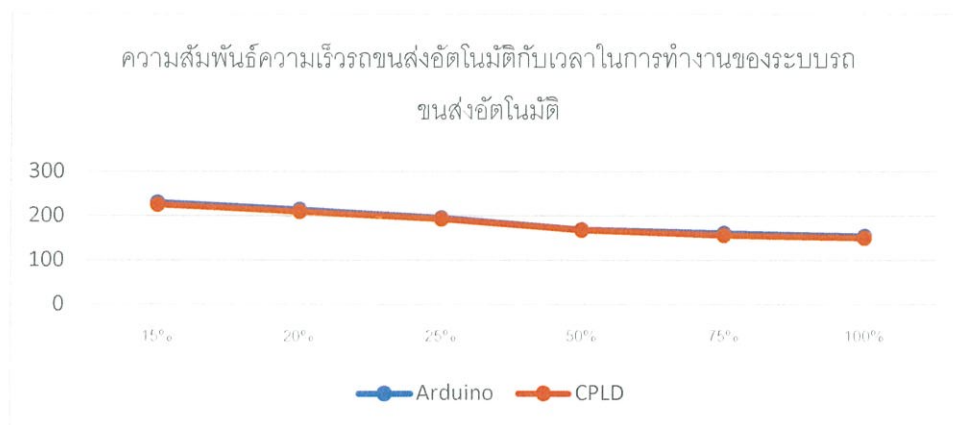
รูปที่ 5.6 แผนภูมิเส้นแสดงความสัมพันธ์ความเร็วรถขนส่งอัตโนมัติกับเวลาในการทำงานของระบบรถขนส่งอัตโนมัติ
