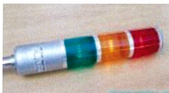
รูปที่ 3.5 ไฟสัญญาณเตือนแบบชั้นแสดงสถานะรถขนส่งอัตโนมัติ
