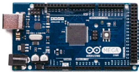
รูปที่ 3.8 อุปกรณ์ควบคุมขนาดเล็ก Arduino รุ่น MEGA 2560
