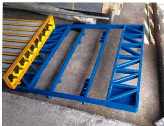
รูปที่ 4.2 การพัฒนาโครงสร้างฐานของรถขนส่งอัตโนมัติ
