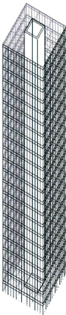
รูปที่ 7-8 แสดงโครงสร้าง Tube in Tube
