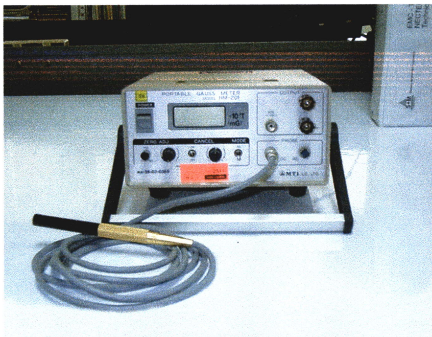
รูปที่ ก-1 เครื่อง Protoble Gauss meter Model HM.201
