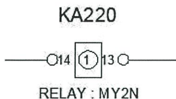
รูปที่ 3.15 สัญลักษณ์ลักษณะในการเขียนแบบของ Relay
