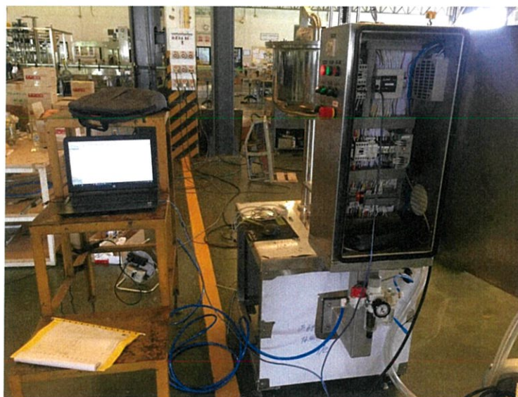
รูปที่ 3.34 ลงโปรแกรมที่ PLC และทดสอบเครื่องจักร
