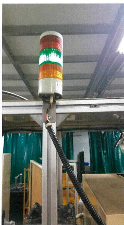
รูปที่ 3.17 การติดตั้งทาวเวอร์ไลท์เข้ากับตัวเครื่องจักร
