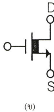
รูปที่ 2.8 มออสทรานซิสเตอร์แบบดีพลีชัน ชนิดเอ็นแชนแนล (ก) โครงสร้าง (ข) สัญลักษณ์
