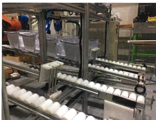
รูปที่ 4.13 แสดงจำนวนกล่องผักที่วางเรียงบนรางลำเลียงกล่องผัก
