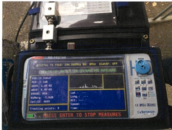
รูปที่ 3.31 ต่อ Attenuation เข้ากับเครื่อง BROADCAST ANALYZERS
