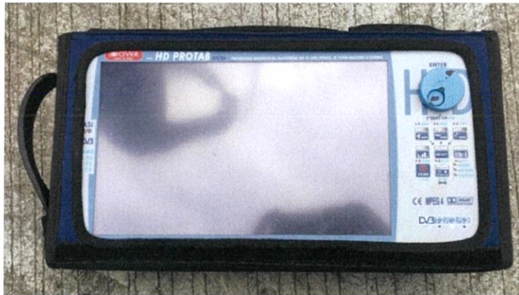
รูปที่ 3.13 เครื่องวัดสัญญาณ BROADCAST ANALYZERS ของ ROVER HD PROTAB
