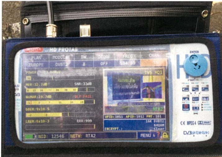
รูปที่ 3.22 เครื่องวัด BROADCAST ANALYZERS ที่ต่อเข้ากับสาย Coaxial cable RG-214
