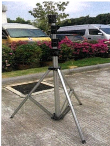
รูปที่ 3.16 เสาสำหรับตั้งสายอากาศ สูง 6 เมตร
