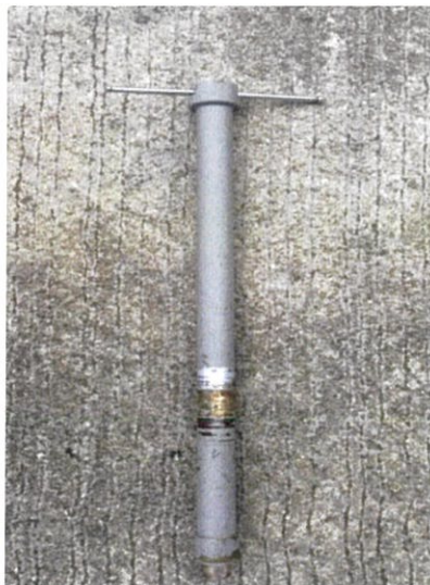
รูปที่ 3.14 สายอากาศไดโพลสำหรับความถี่ย่าน UHF
