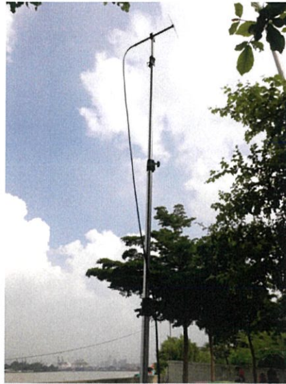
รูปที่ 3.24 ปรับความยาวของเสาตั้งให้มีความสูง 6 เมตร
