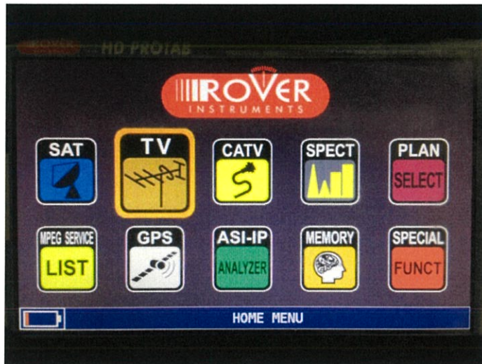
รูปที่ 3.26 หน้าจอเริ่มต้นของเครื่องวัดสัญญาณ BROADCAST ANALYZERS
