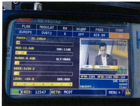
รูปที่ 3.27 ภาพและพารามิเตอร์ที่อ่านได้จาก BROADCAST ANALYZERS
