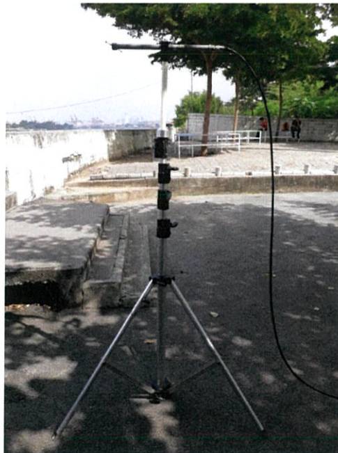
รูปที่ 3.21 สายอากาศไดโพลที่ประกอบกับเสาตั้งและสาย Coaxial Cable RG-214
