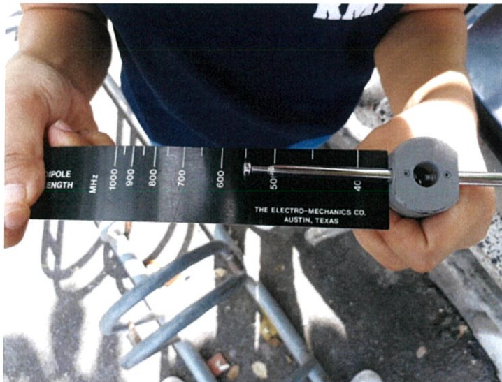
รูปที่ 3.23 ปรับความยาวของสายอากาศไดโพลให้ตรงกับความถี่ของสัญญาณในแต่ละ mux
