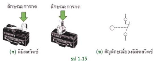
รูปที่ 2.31 ตัวอย่างการทำงานลิ้มิตสวิตช์
