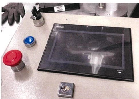
รูปที่ 4.4 หน้าจอสั่งงานด้วย Touchscreen
