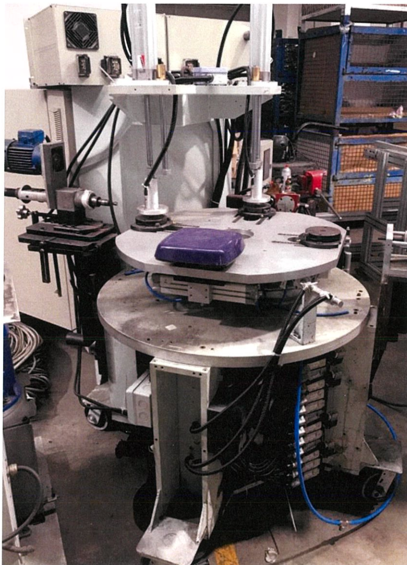
รูปที่ 4.6 ภาพเครื่องเชื่อมเม็ดสตัดที่ประกอบเสร็จแล้ว
