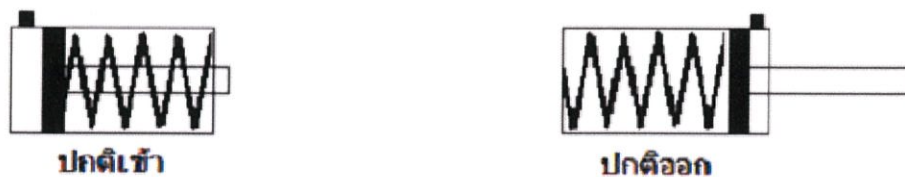
รูปที่ 2.11 การทำงานของกระบอกลูกสูบทางเดียวทั้ง 2 ประเภท
