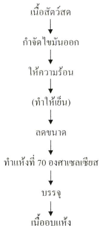
รูปที่ 2.2 ขั้นตอนการทำเนื้ออบแห้งในระดับอุตสาหกรรม
