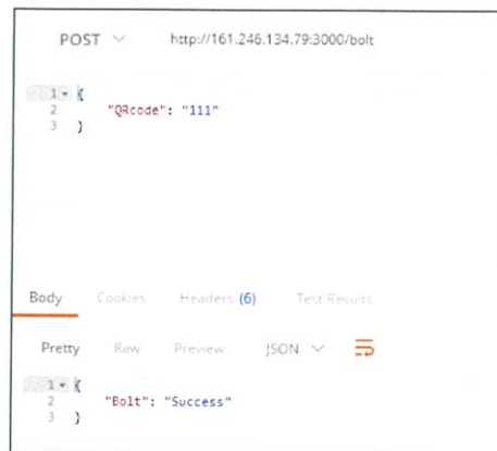
รูปที่ 4.46 การทดสอบการรับ-ส่งข้อมูลด้วยโปรแกรม Postman
