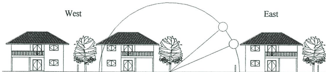
ภาพที่ 4.3 แสดงอิทธิพลของรังสีดวงอาทิตย์ขณะที่ทำมุม Altitude ต่ำด้านทิศตะวันออก
