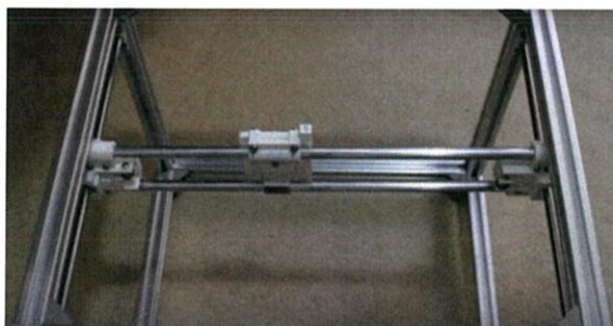
รูปที่ 3.6 ลักษณะการรวมอุปกรณ์ชุดเลื่อนกลิ้งสองแกนเคลื่อนที่ในแนวแกน X และ Y
