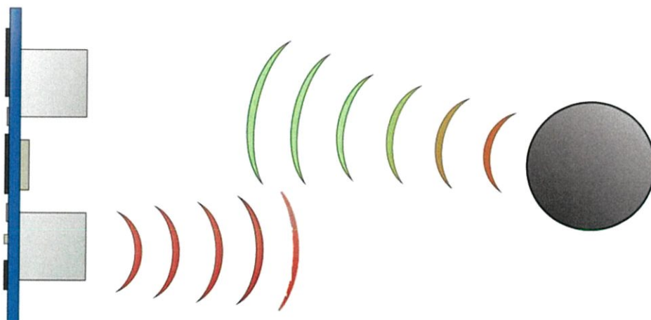
รูปที่ 2.7 หลักการทำงานของ Ultrasonic Sensor module [5]
