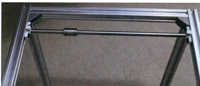
รูปที่ 3.5 การประกอบอุปกรณ์ชุดเลื่อนกลิ้งสองแกนเคลื่อนที่ในแนวแกน Y
