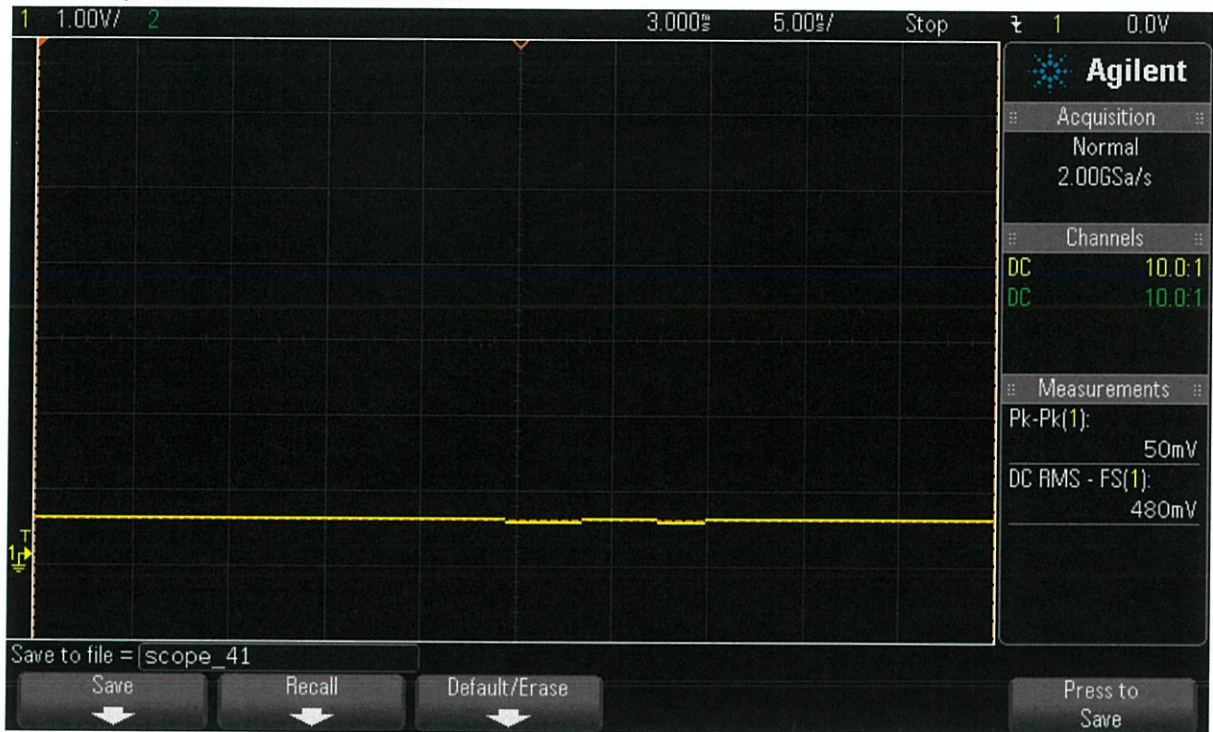
รูปที่ 4.7 สัญญาณแรงดันเอาต์พุต TCRT5000 กรณีวัดพื้นที่ผิวสกปรก ระยะ 1 cm
