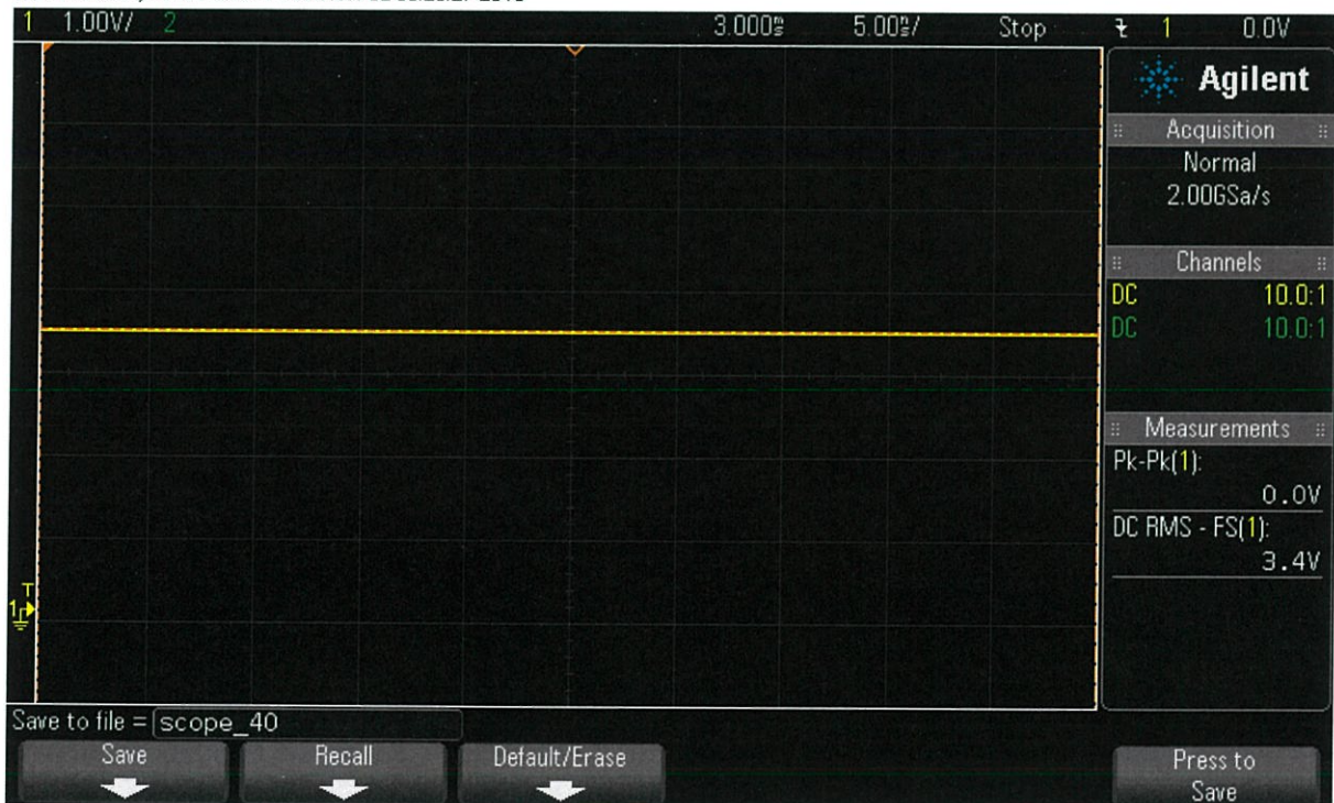
รูปที่ 4.8 สัญญาณแรงดันเอาต์พุต TCRT5000 กรณีวัดพื้นที่ผิวสกปรก ระยะ 3 cm
