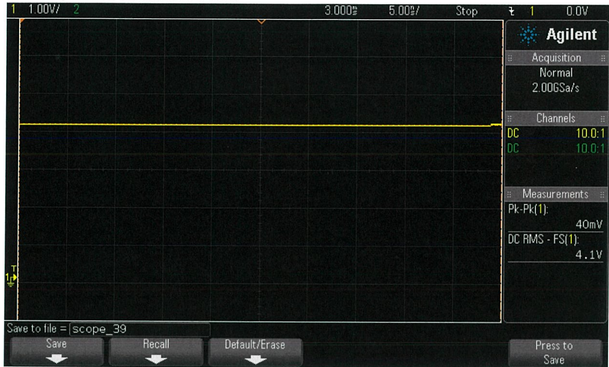
รูปที่ 4.9 สัญญาณแรงดันเอาต์พุต TCRT5000 กรณีวัดพื้นที่ผิวสกปรก ระยะ 6 cm
