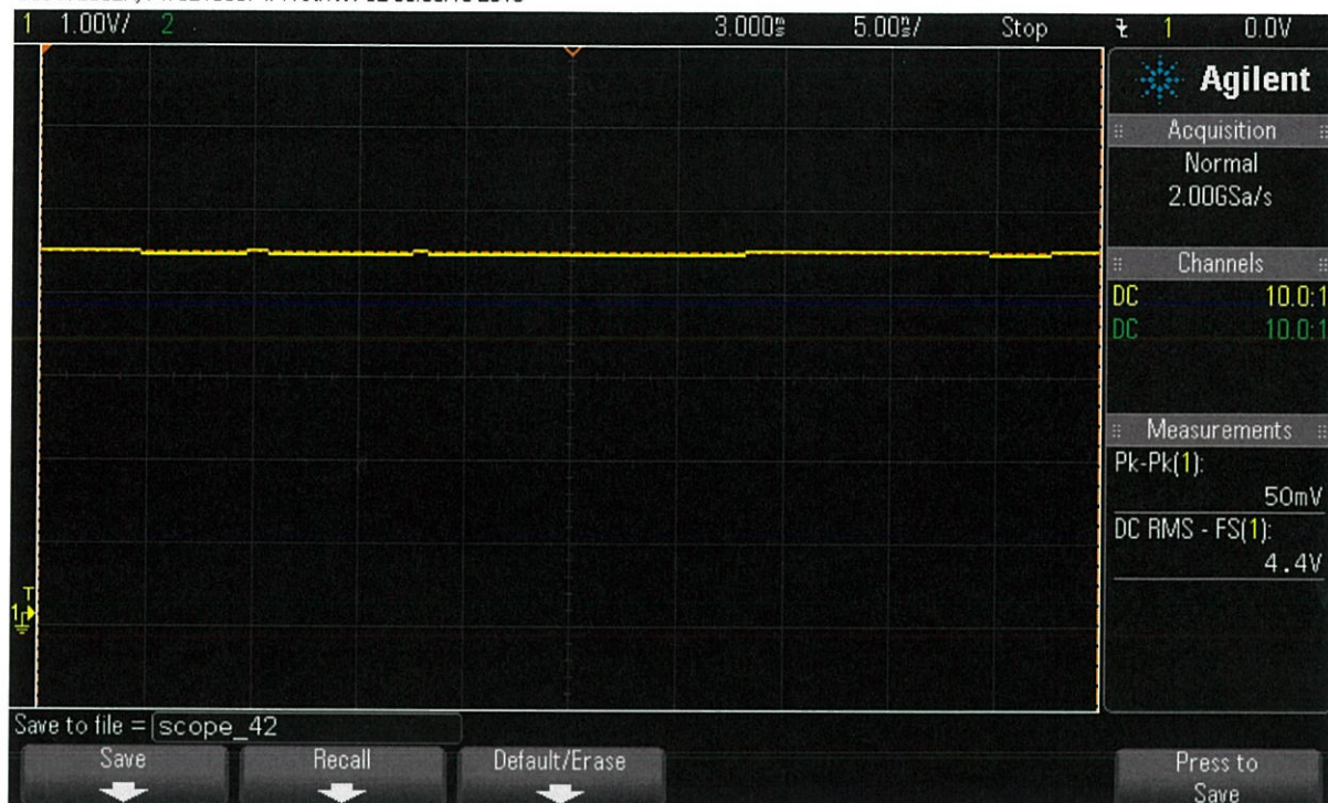
รูปที่ 4.17 สัญญาณแรงดันเอาต์พุต TCRT5000 กรณีวัดพื้นที่ผิวเป็นสี่เหลี่ยม ระยะเวลา 12 cm
