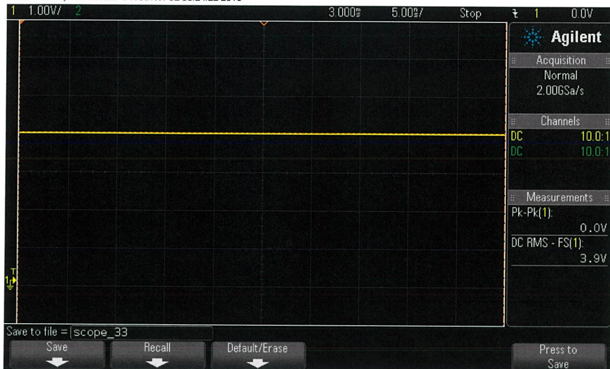
รูปที่ 4.3 สัญญาณแรงดันเอาต์พุต TCRT5000 กรณีวัดพื้นที่ผิวเป็นสีขาว ระยะ 6 cm
