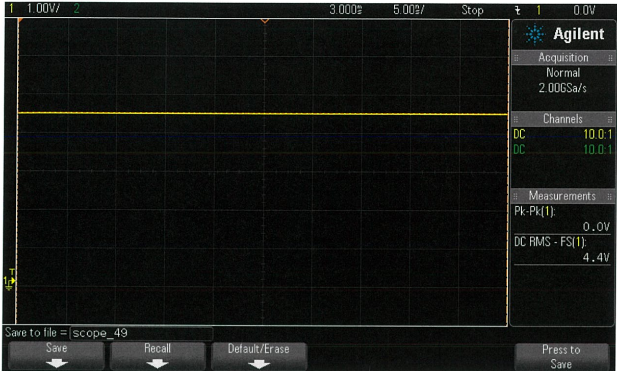
รูปที่ 4.21 สัญญาณแรงดันเอาต์พุต TCRT5000 กรณีวัดพื้นที่ผิวเป็นสีดำ ระยะ 6 cm
